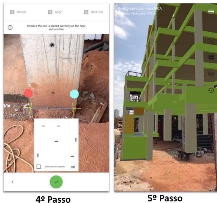
Figura 13 - Etapas de lançamento do projeto 3D no aplicativo RA.
