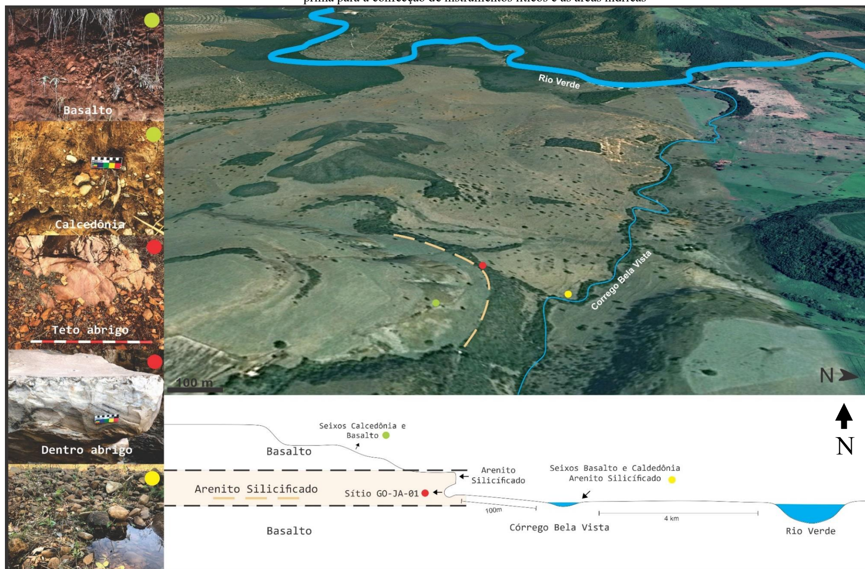
Figura 21- Perfil no sentido NE da área de entorno do abrigo GO-JA-01, demonstrando como ele está inserido na paisagem. Com ênfase nos locais para a obtenção de matéria-prima para a confecção de instrumentos líticos e as áreas hídras
