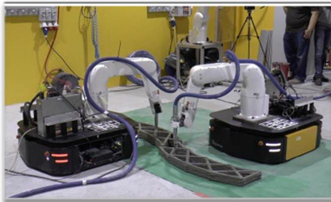
Figura 6- Impressão 3D para construção civil
