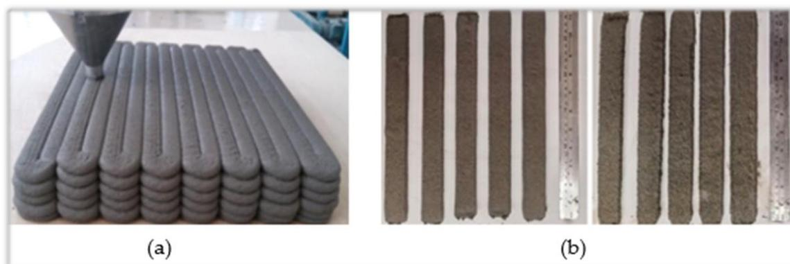
Figura 10 - Testes de extrudabilidade em seção oval (a) e retangular (b): Realizado por (a) Ma *et al.* (2019) e (b) Arunothayan *et al.* (2020)
